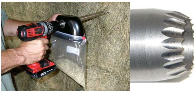
Se debe tener la precaución de introducir el calador de manera perpendicular al material y repetir este procedimiento al menos 2 o 3 veces por cada rollo o fardo. En el caso de los rollos, este procedimiento se realiza por la cara redonda del mismo.
